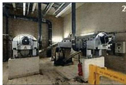
Elles sont ensuite dirigées vers un séchoir thermique (à gauche) qui termine la déshydratation. Finalement elles sont transformées en granulés puis conditionnées dans des sacs de stockage.
