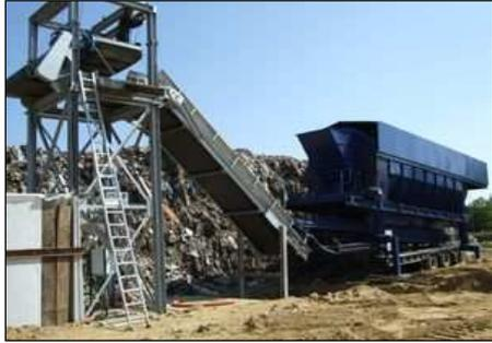
*Séparer à l'aide d'un trommel et d'overbands les différentes fractions*
